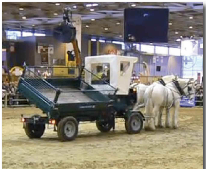
Présentation au salon de l'agriculture 2011 du prototype d'Hippoben (véhicule hippomobile à 4 roues, tribenne et grue hydraulique) construit par l'Ets Perrier sur un cahier des charges de l'atelier de Vincennes et de l'association HIPPOTESE.
